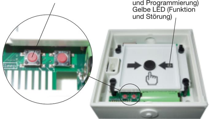
2. Die gelbe LED blinkt 5 Sekunden und anschließend einmal alle 10 Sekunden. Diese Anzeige signalisiert den Normalbetrieb des Melders.
