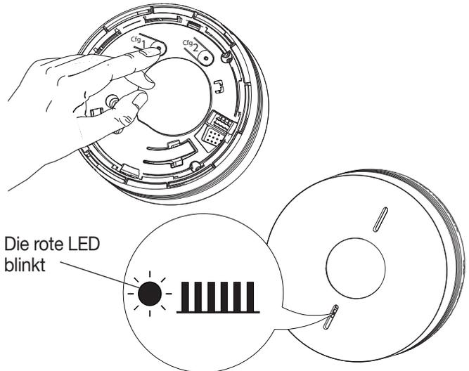
2. **Alle** zu vernetzenden Austauschmodule in den Einlernbetrieb schalten; **dazu zweimal die Cfg1-Taste betätigen.**
