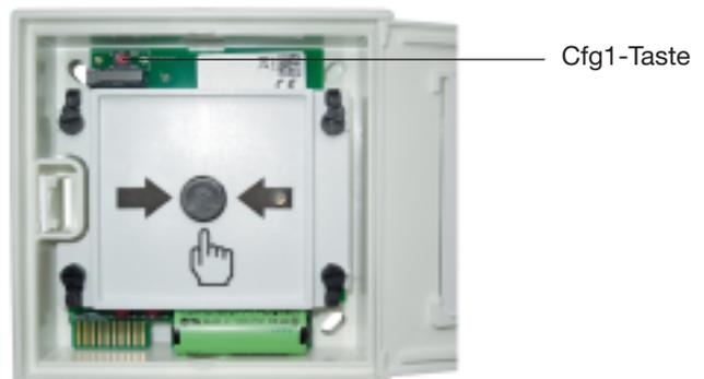
**3. Die Test-Taste** des bereits vernetzten Melders **so lange gedrückt halten, bis die rote LED aller zu vernetzenden Melder dauerhaft leuchtet.** Taste loslassen; die rote LED des Melders blinkt.
