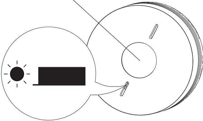
**4. Um den Einlernmodus zu beenden, kurz die Cfg1-Taste aller Melder und des Druckknopfmelders betätigen.** Die rote LED auf den Meldern und auf dem Druckknopfmelder erlischt. Betätigt man die Cfg1-Taste nicht, verlassen die Melder und der Druckknopfmelder den Einlernmodus automatisch nach einer Minute. Die Vernetzung der Melder und des Druckknopfmelders wird in beiden Fällen gespeichert.
