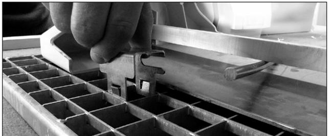
Klemmbügel von Hand oder mit dem Fuß in den seitlichen Ausschnitt des Klemmbügelhalters einschwenken und über die Arretierungsnase drücken.
