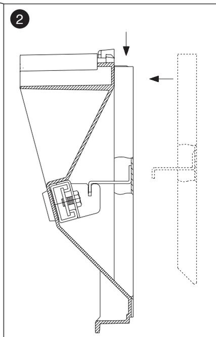
1. Links und rechts je eine Mutter einlegen und Haltewinkel mit Schraube befestigen.
