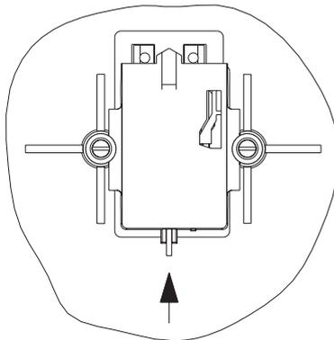
3. Verriegelung ansetzen (Durchbruch auf rechter Seite), durch mitgelieferte Spezialschrauben gegen Herausfallen sichern.
