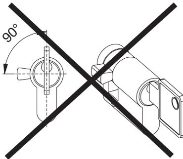
**Profilzylinder mit dieser Schließbartstellung (abgesperrt) dürfen nicht verwendet werden!**
