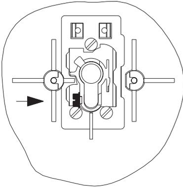
1. Frontseitige Schlossabdeckung mit Schlüssel bzw. Schraubendreher öffnen.
