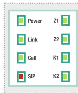
**Z1-Z2 (grün)** leuchtet dauerhaft: Der Kontakt ist aktiviert, wenn eine Spannung zwischen 12 V und 24 V (Vca/Vcc) anliegt.
