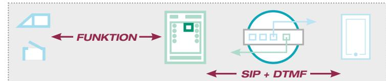
Mit Hilfe der Funktion "Remote I/O" kann das SIP-Relais direkt über das Türmodul (Türstation) gesteuert werden. Dies ermöglicht die sichere Steuerung von elektromechanischen Funktionen, wie Türöffner oder Beleuchtung.
