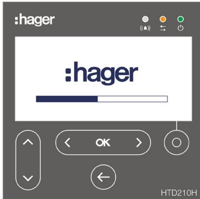
Während der Startbildschirm angezeigt wird, ruft das Türeinbau-Display die im Kompaktleistungsschalter Energy gespeicherten Konfigurationseinstellungen ab. Wenn die gespeicherten Daten beschädigt oder leer sind (z.B. beim erstmaligen Einschalten), werden Standardwerte eingestellt.
