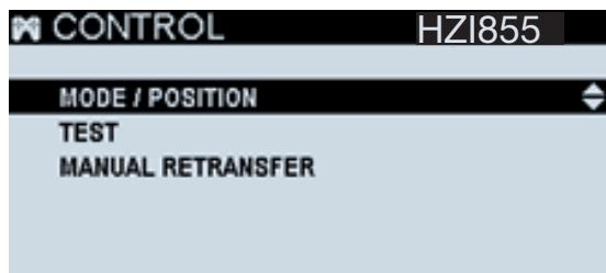
**MODO / POSICIÓN:** permite cambiar el modo de funcionamiento, cambiar de posición en modo CTRL y arrancar / parar los grupos electrógenos de forma remota (también en modo CTRL)
