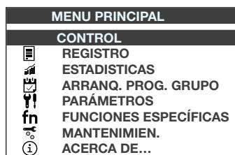
**CONTROL** - Este menú permite cambiar el modo de operación, así como probar órdenes de posición y señales de arranque del motor. (Ver capítulo 10.6)
