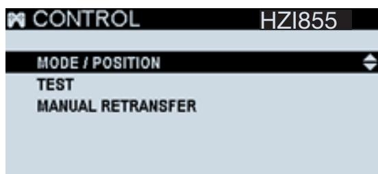
**MODE / POSITION** : permet de changer le mode de fonctionnement, de changer de position en mode CTRL et de démarrer / arrêter les groupes électrogènes à distance (également en mode CTRL)
