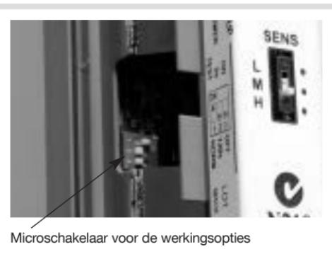
**OPGELET:** indien u de microschakelaar 2 of de microschakelaar 3 op ON zet, zal de autonomie verminderen.
