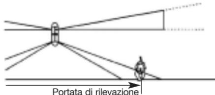
**Nessuna rilevazione: solo il fascio superiore è interrotto**
