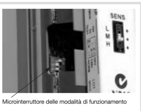
**ATTENZIONE: posizionando i microinterruttori 2 o 3 in ON, l'autonomia della pila verrà ridotta.**
