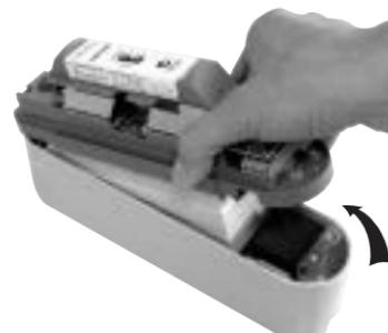
3. Gehäuse des Funkteils öffnen.
