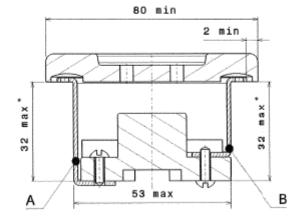
Dimensions maximales d'encombrement de la base.
