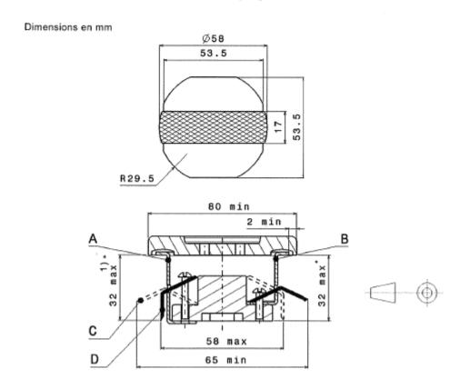
Dimensions maximales d'encombrement de la partie principale 2)
