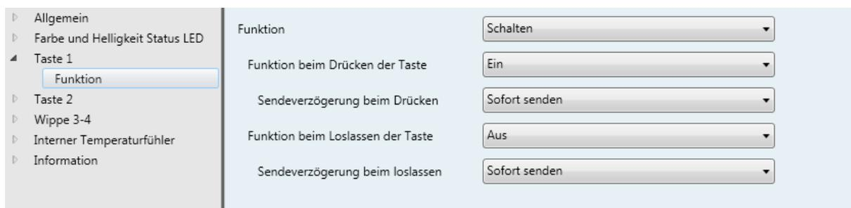
Bild 16: Parameter „Funktion der Taste beim Drücken / Loslassen“
