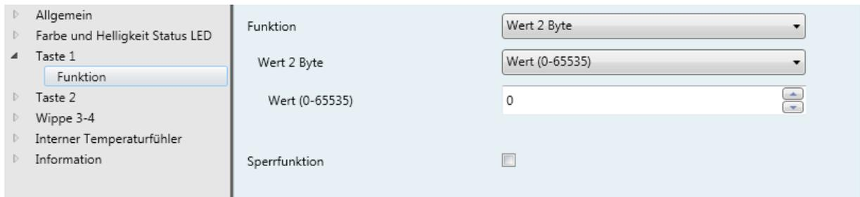
Bild 24: Funktion der Einzeltaste „Wert 2-Byte“
