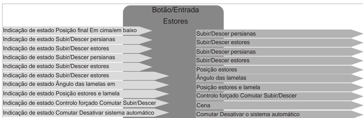
Figura 8: Sinais de entrada/saída Função estores
