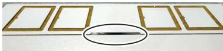
Cordon de silicone au niveau du thermocouple
