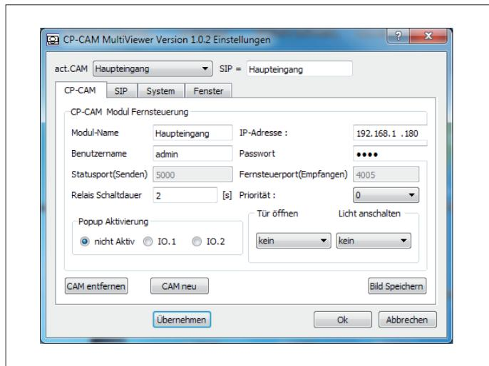
Bei der ELCOM MultiViewer-Software handelt es sich um ein Computer-Programm für MS-Windows kompatible Desktop-Betriebssysteme. Die Software ermöglicht es Ihnen, das Videobild des IP-Kameramoduls CBS-300 in Kombination mit dem IP-Türlautsprecher-Modul LBM-300 auf dem PC-Bildschirm anzuzeigen. Unterstützt werden eine fast unbegrenzte Anzahl an Kameras, die Ansteuerung von in den Modulen integrierter Schaltrelais sowie das Speichern von Bildern und Videos.
