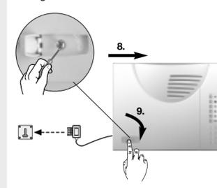
7. Raccorder la centrale au réseau téléphonique (se reporter au guide d'installation pour le raccordement).
