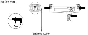
2. Insérer la rondelle et fixer le T à l'aide de vis et de chevilles appropriées.
