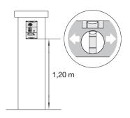
2. Repérer et percer les trous de fixation de la platine de rue avec un forêt de  $\varnothing$  6 mm.
