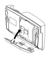
6. Si besoin, remettre la base sur le T de fixation.
