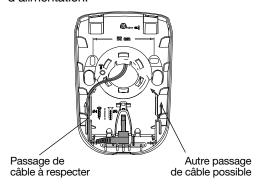
**11.** Passer le câble d'alimentation dans l'un des guide au dos de la base.
