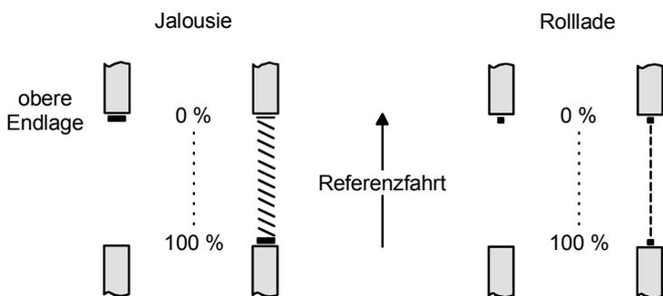
Eine Referenzfahrt ist eine um 20 % und zusätzlich um die parametrisierte Fahrzeitverlängerung verlängerte Fahrzeit in die obere Endlage. Die Fahrzeit kann für jeden Ausgangskanal getrennt eingestellt werden. Eine Referenzfahrt ist nicht nachtriggerbar.
