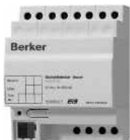
Der Schaltaktor empfängt Telegramme über den EIB und schaltet mit seinen sechs potentialfreien, voneinander unabhängigen Relaiskontakten Gruppen von elektrischen Verbrauchern. Es können verschiedene Außenleiter angeschlossen werden. Die Applikation ermöglicht Schalten mit Rückmeldung, Verknüpfung und Zeitfunktion.
