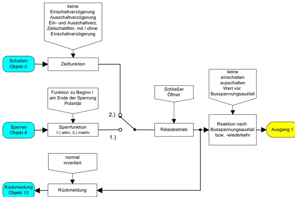
**Funktionsschaltbild (z.B. Ausgang 1 mit der Zusatzfunktion „Zwangsstellungobjekt“)**
