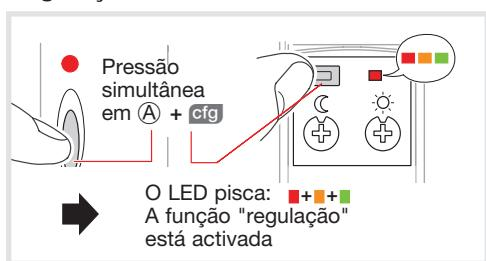
Os níveis de luminosidade são regulados com a ajuda dos 2 potenciômetros. A cor do LED cfg (ver ilustração D) indica o resultado da comparação entre a luminosidade medida pelo sensor e o nível regulado no potenciômetro.
