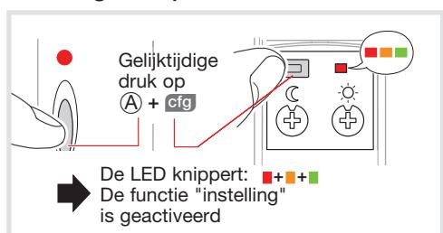
De drempelwaarden van de lichtsterkte worden ingesteld met behulp van de 2 potentiometers. De kleur van de LED cfg (zie illustratie D) geeft het resultaat van de vergelijking tussen de door de sensor gemeten lichtsterkte en de op de potentiometer ingestelde drempelwaarde.
