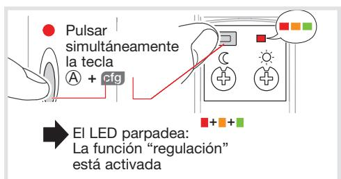
Los umbrales de luminosidad se regulan mediante 2 potenciómetros. El color del LED cfg (ver diagrama D) indica el resultado de la comparación entre la luminosidad medida por el sensor y el umbral regulado en el potenciómetro.
