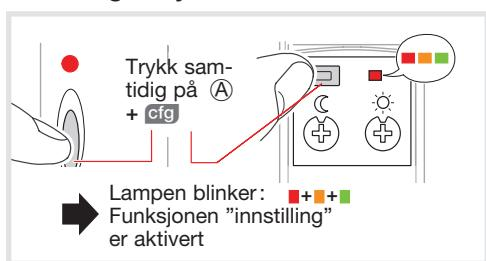
Lystersklenes stilles inn med 2 potensiometre. Fargen på cfg-lampen (konfigurasjon) (se illustrasjon D) angir resultatet av sammenligningen mellom lysstyrken som måles av føleren, og terskelen som er stilt inn på potensiometeret.
