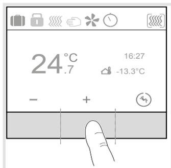
Figura 5: Aree del tasto della superficie di comando Touch
