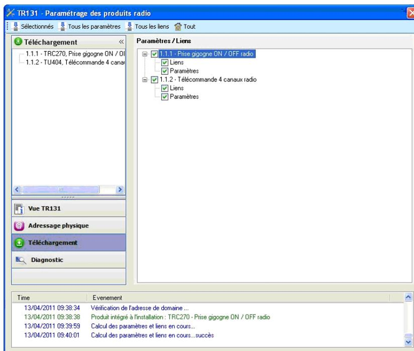
Attention : Le plug-in du TR131 doit être désactivé lors des tests fonctionnels.
