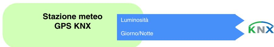
Il valore della luminosità è inviato ogni 30 minuti e a ogni variazione di luminosità, se questa è superiore al 20 % rispetto all'ultimo rilevamento.
