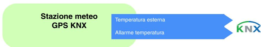
Il valore della temperatura è inviato ogni 30 minuti e a ogni variazione di temperatura se questa è superiore a +/- 0.5°C rispetto all'ultimo rilevamento.
