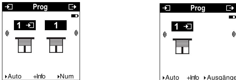
Der Modus +Info ermöglicht das Verbinden der Zustandsanzeige eines Ausgangs mit einem Anzeigegerät: Raumtemperaturregler, Ausgang vom Typ LED, etc.
