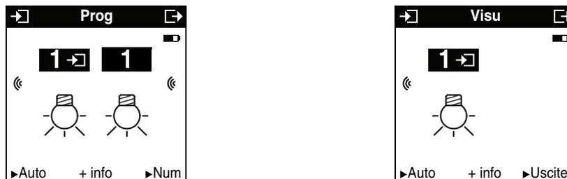
Il modo +Info consente di collegare l'indicazione dello stato di un'uscita a uno strumento di visualizzazione : Unità di controllo atmosfera, uscita tipo LED, ecc.
