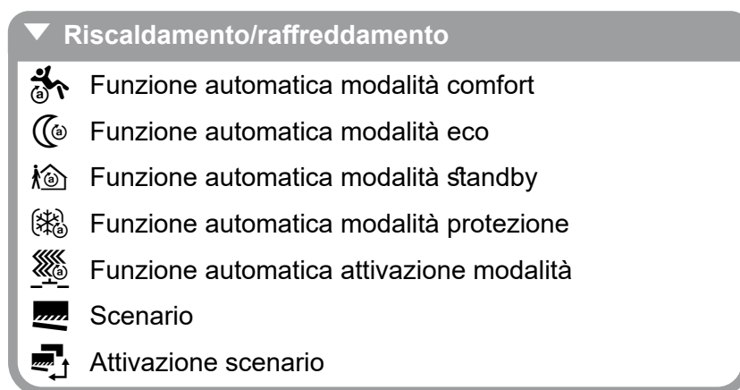
Figura 59: Panoramica delle funzioni Riscaldamento/raffreddamento
