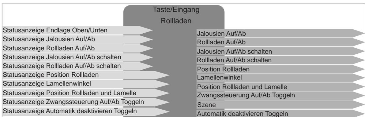
Bild 8: Ein-/Ausgangssignale Funktion Rollläden
