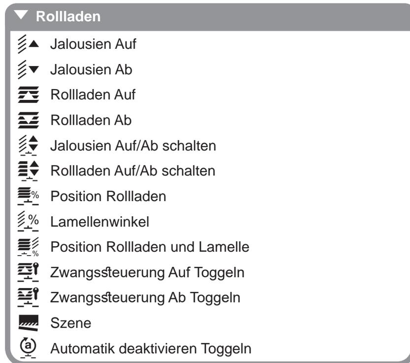
Bild 45: Funktionsübersicht **Rollladen**
