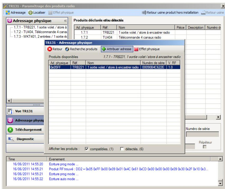
Le bouton **Effet physique** permet d'identifier et localiser le produit sélectionné.
