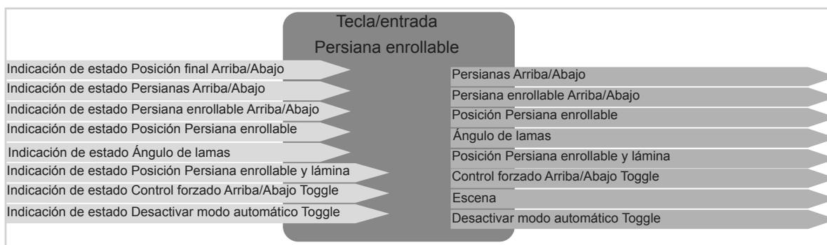
Figura 6: Señales de entrada/salida Función Persiana enrollable
