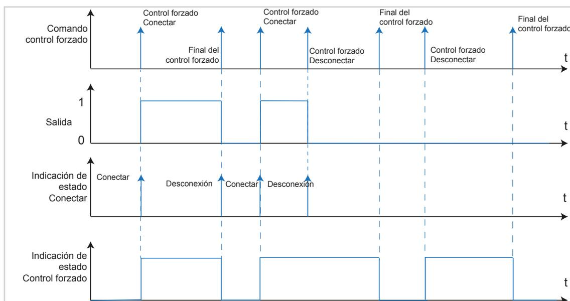
Figura 22: Gráfico señal-tiempo de control forzado
