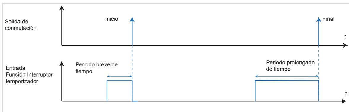
Figura 19: Gráfico señal-tiempo interruptor temporizador
