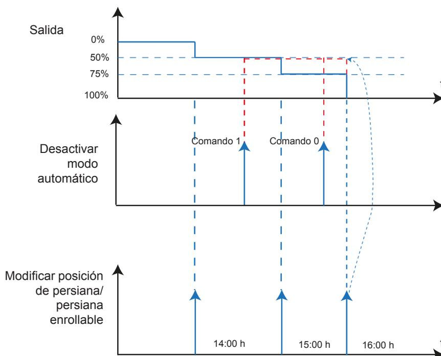
Figura 53: Gráfico señal-tiempo Desactivar modo automático
