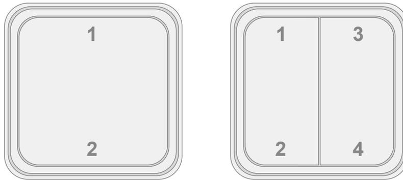
Figura 3: Asignación teclas/entradas - numeración en la herramienta de configuración de 2 elementos
