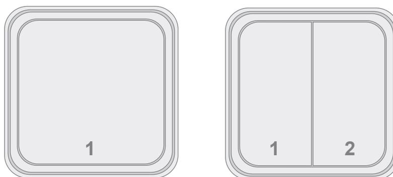
Figura 2: Asignación teclas/entradas - numeración en la herramienta de configuración de 1 elemento
