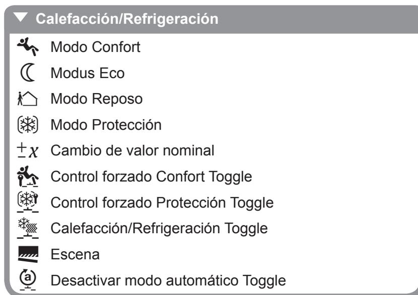
Figura 55: Vista general de las funciones **Calefacción/Refrigeración**
