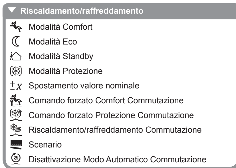
Figura 55: Panoramica delle funzioni Riscaldamento/raffreddamento
