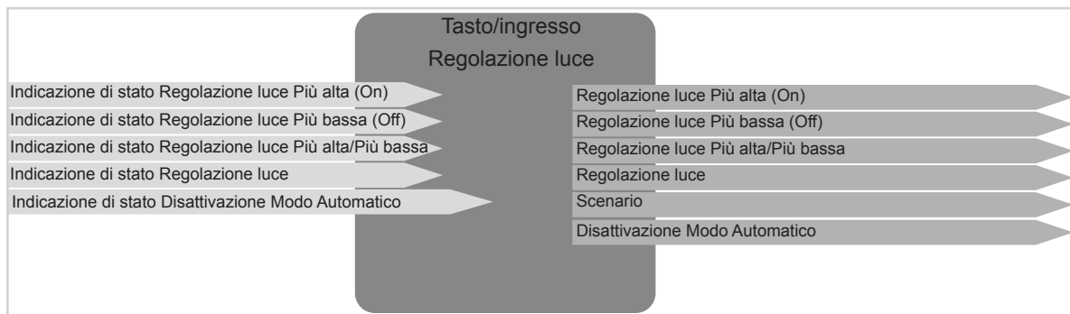
Figura 5: Segnali di ingresso/uscita funzione Regolazione luce
