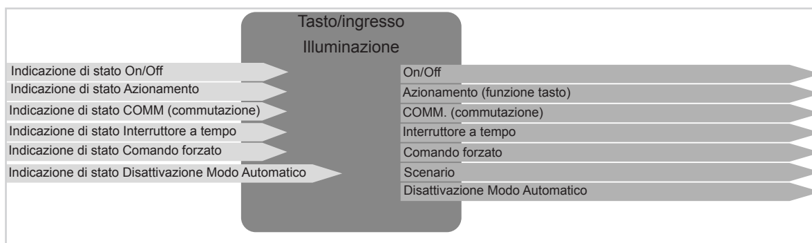
Figura 4: Segnali di ingresso/uscita funzione illuminazione
