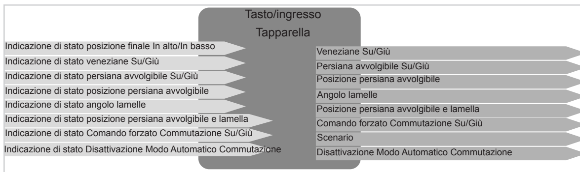
Figura 6: Segnali di ingresso/uscita funzione Persiana avvolgibile
