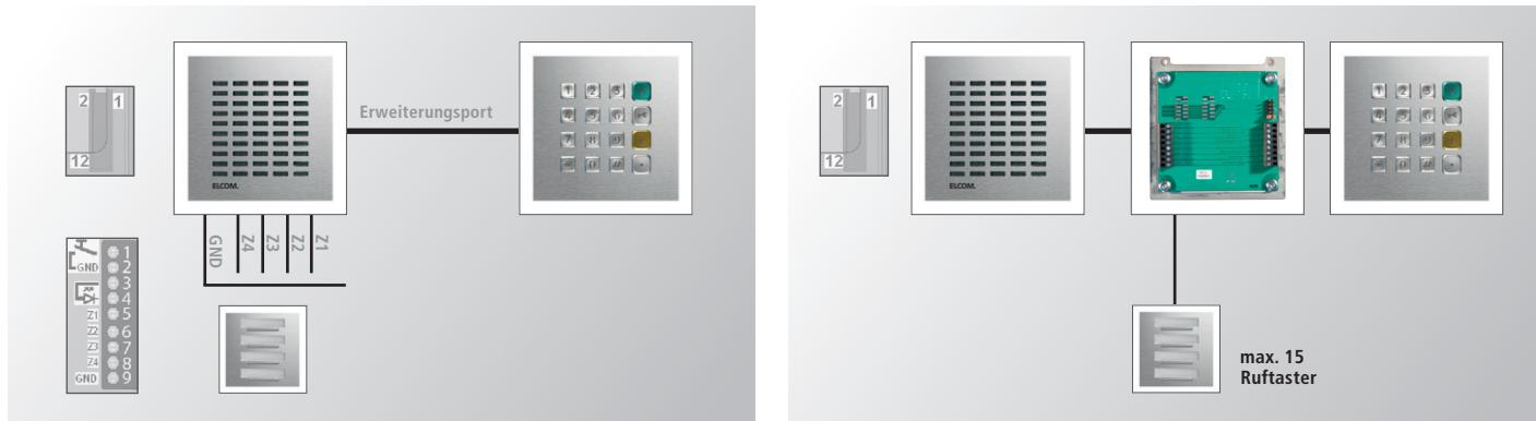
Bei Einsatz eines einzelnen Moduls können die Anschlüsse Zentralruftaste und Direktruftasten ebenfalls genutzt werden.
