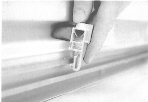
1. Stecktürme im Raster 150 mm mit den Zapfen in die großen Löcher der Tragschiene einstecken und bis zum Einrasten nach hinten drücken.
