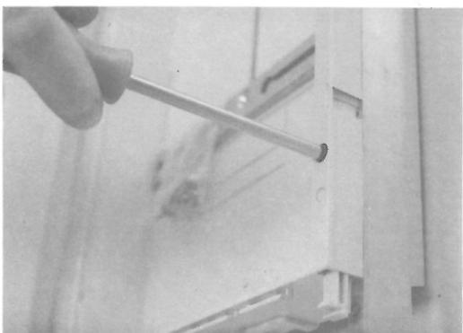
2. Tragplatte mit beiliegenden Kerbschrauben zwischen Bausteingrenzen auf den Tragschienen montieren.
