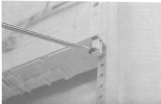
1. Die beiden Sperrschieber nach unten ziehen, bis die unteren Befestigungslöcher frei sind.
