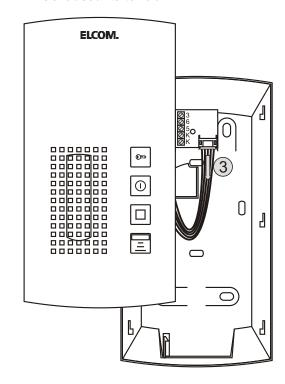
Montieren Sie den Gehäuseboden und schliessen Sie die Zuleitung an.
