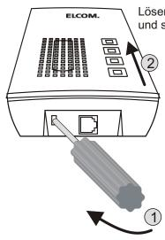
Lösen Sie mit einem Schraubendreher die Verriegelung und schieben Sie den Gehäusedeckel nach oben.
