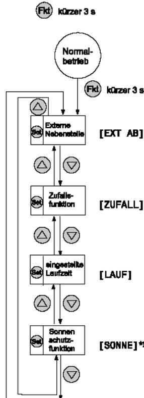
Zurück in den Normalbetrieb mit **[Esc]** oder automatisch nach 2 min. ohne Tastendruck.
