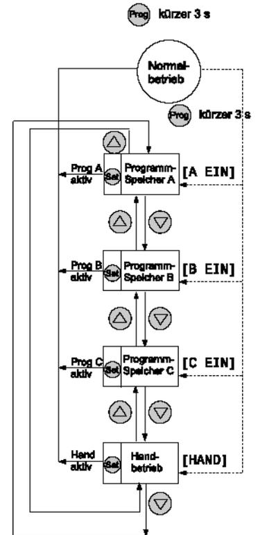
Zurück in den Normalbetrieb mit **[Esc]** oder automatisch nach 2 min. ohne Tastendruck.
