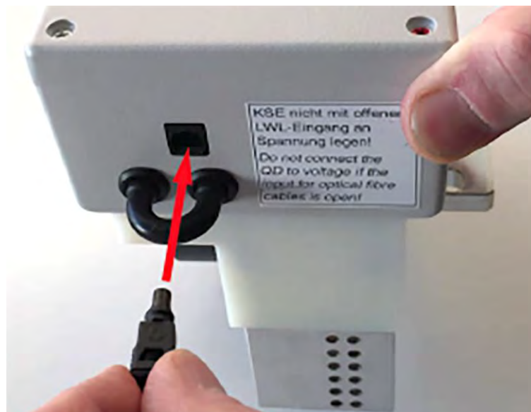
Herstellung der LWL-Verbindung am Löschergerät (Beispiel: SPBKS)
