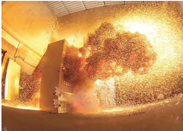
Provozierter Störlichtbogen bei fehlendem Störlichtbogen-Schutzsystem.
