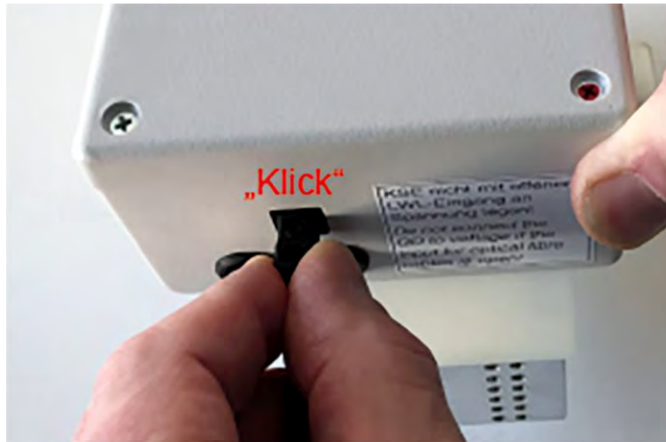
LWL-Verbindung am Löscherät einrasten (Beispiel: SPBKS)
