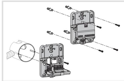
Für eine optimale Wärmeregulierungsqualität die Unterputzdose bzw. den Kabelkanal abdichten.
