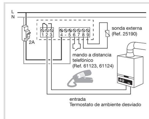
**Conexión del termostato a una entrada termostato de una bomba de calor (PCA) reversible o no**
