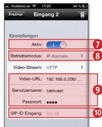
Der Videoserver in Kombination mit dem Türlautsprecher-Modul und eine weitere externe IP-Kamera zur Überwachung sind damit in den Videofon-Clients eingebunden.
