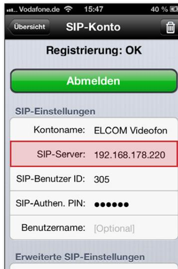
Im Setup der ELCOM Videofon APP unter „Benutzerkonten“ wird die neue IP-Adresse des ISS-300 eingeben (hier 192.168.178.220) und danach registriert.
