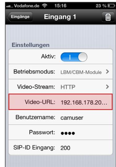
Unter „Eingang & Kamera“ bei Eingang 1 usw. die Video-URL der jeweiligen CBM-300 IP-Kamera anpassen (hier 192.168.178.200). Fertig.
