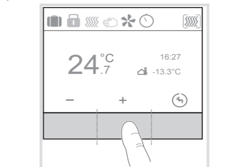
Figure 5 : Zones sensorielles de la surface de commande tactile
