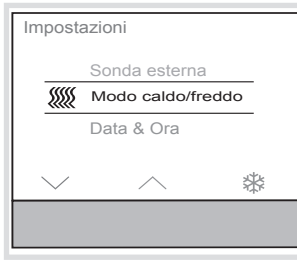
Figura 9: Selezione della modalità di riscaldamento/raffreddamento
