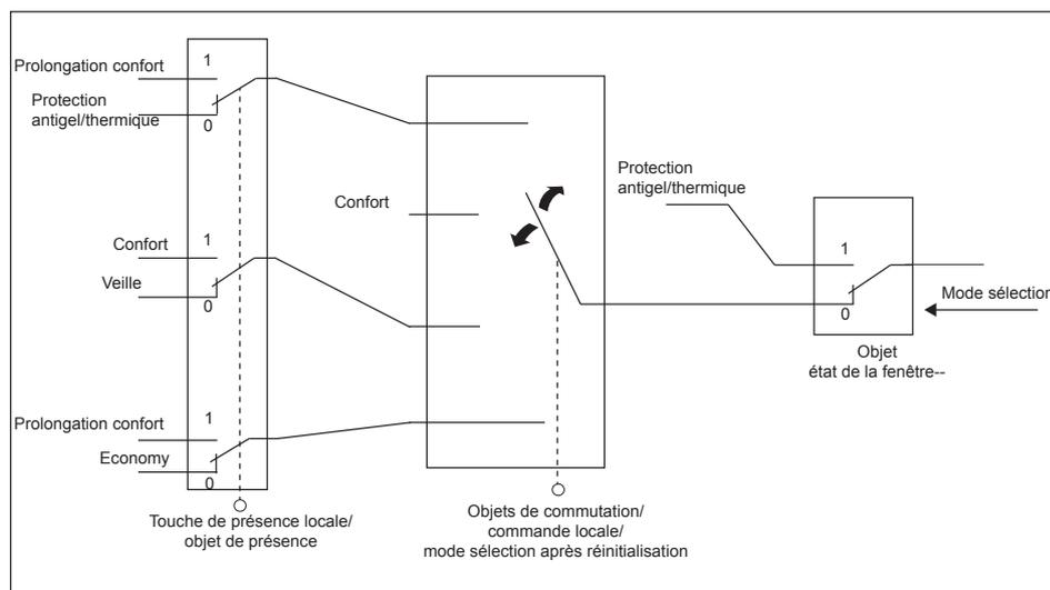
Image 16: Diagramme « Commutation de mode de fonctionnement via objet avec objet de présence » (4x1 bit)
