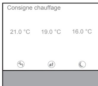
Sélectionner le mode de fonctionnement dont la valeur demandée de température doit être modifiée sous « Valeur demandée de chauffage ». Par exemple le mode Nuit.
