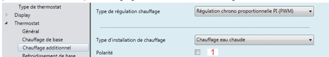
Image 19: Thermostat d'ambiance - chauffage additionnel
