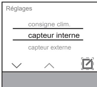
Sélectionner le paramètre « Sonde de température interne » sur la page Réglages à l'aide des touches fléchées  $\wedge$  /  $\vee$  et confirmer avec
