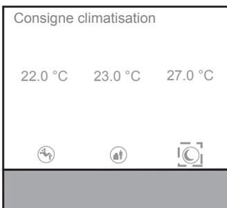
Sélectionner le mode de fonctionnement dont la valeur demandée de refroidissement doit être modifiée sous « Valeur demandée de chauffage ». Par exemple le mode Nuit.
