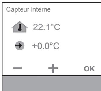
Dans le paramètre « Sonde de température interne », ajuster la température à l'aide des touches + /- puis confirmer avec OK.
