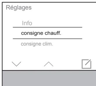
Sélectionner le paramètre « Valeur demandée de chauffage » sur la page Réglages à l'aide des touches fléchées  $\wedge / \vee$  et confirmer avec
