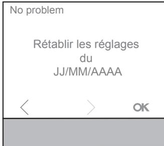
La page Aucun problème (No problem) permet de rétablir une variante de réglage antérieure de l'appareil. Les variantes ETS créées et les derniers réglages modifiés sur l'afficheur sont enregistrés.
