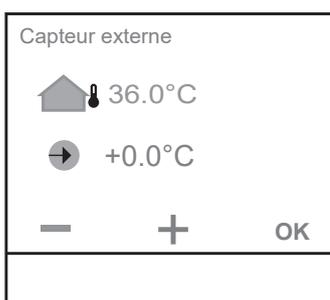
Dans le paramètre « Capteur externe », ajuster la température à l'aide des touches + /- puis confirmer avec **OK**.
