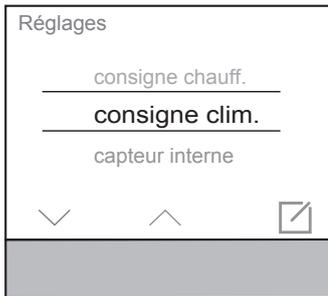
Sélectionner le paramètre « Valeur demandée de refroidissement » sur la page Réglages à l'aide des touches fléchées  $\wedge$  /  $\vee$  et confirmer avec
