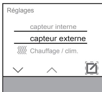
Sélectionner le paramètre « Sonde de température externe » sur la page Réglages à l'aide des touches fléchées  $\wedge$  /  $\vee$  et confirmer avec
