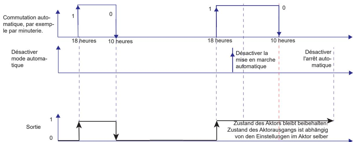
Image 45: Fonction Automatisme pour commande de commutation/basculement
