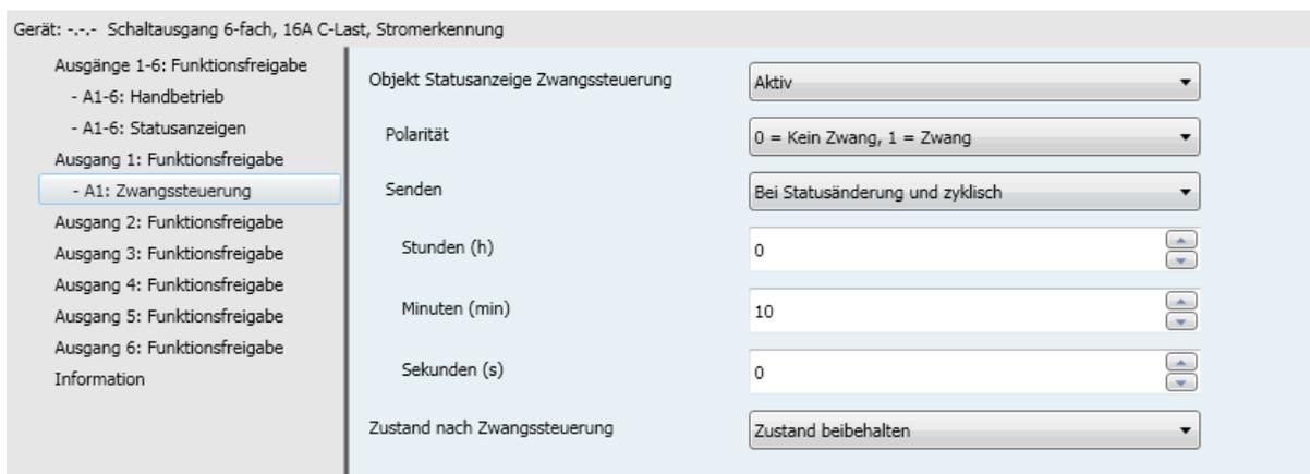
Mit der Zwangssteuerfunktion kann für einen Ausgang ein vordefinierter Zustand erzwungen werden.
