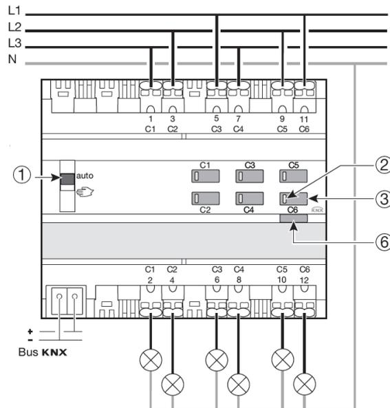
Die Schaltausgänge können an unterschiedliche Phasen angeschlossen werden.
