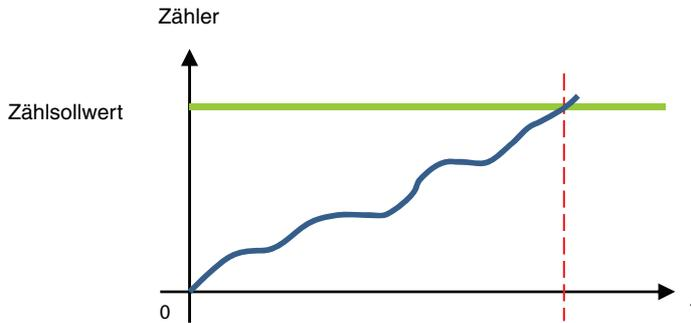
Der Zähler beginnt ab dem Wert 0 nach oben zu zählen. Sobald der Zählsollwert (Objekt **Betriebsstundenzählsollwert**) erreicht ist, wird das Objekt **Betriebsstundenzähl. erreicht** auf 1 gesetzt und an den Bus geschickt.
