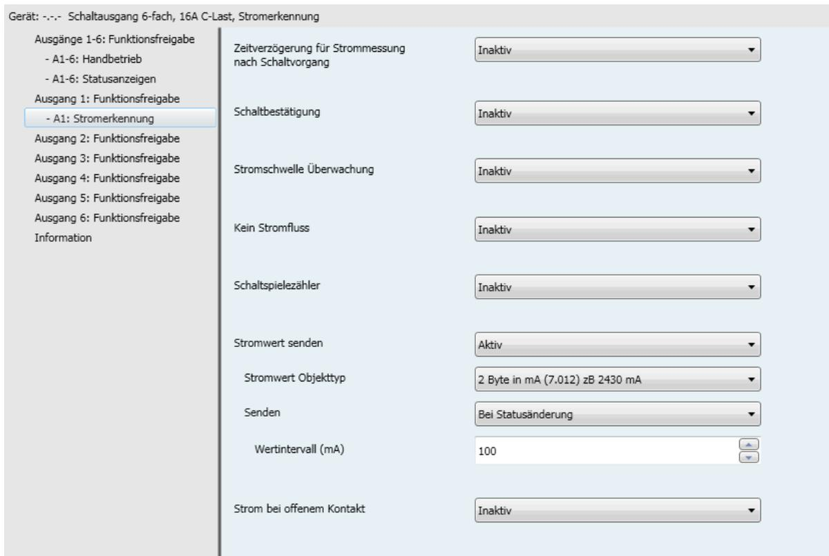
Diese Funktion ermöglicht das Versenden des Stromwerts an den KNX-Bus.
