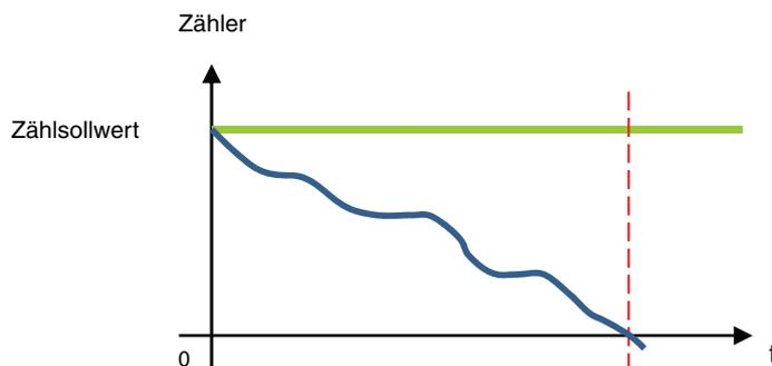
Der Zähler beginnt ab dem Betriebsstundenzählsollwert (Objekt **Betriebsstundenzählsollwert**) nach unten zu zählen. Sobald der Zähler bei 0 angekommen ist, wird das Objekt **Betriebsstundenzähl. erreicht** auf 1 gesetzt und an den Bus geschickt.
