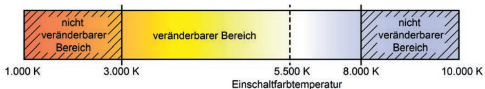
Bild 35: Beispiel eines konfigurierten Farbtemperaturbereichs mit Einschaltfarbtemperatur
