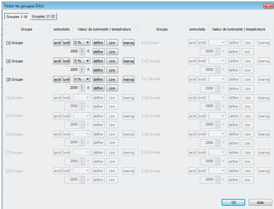
Figure 82: Environnement de test DALI orienté sur les groupes (exemple avec trois groupes créés)
