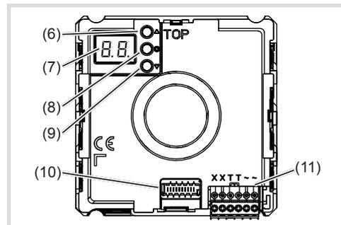
Bild 4: Geräteaufbau Audio Module und Audioeinsatz Rückseite
