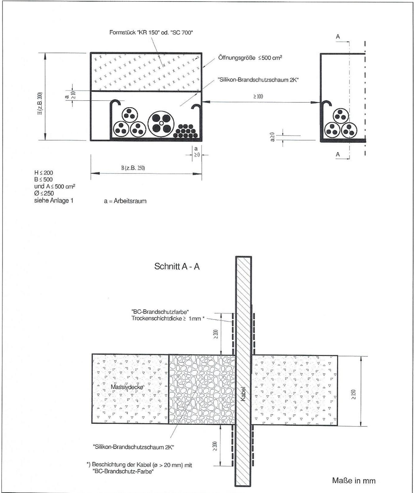
Feuerwiderstandsfähige Abschottung für elektrische Leitungen "System Silikon-Brandschutzschaum S 90"
