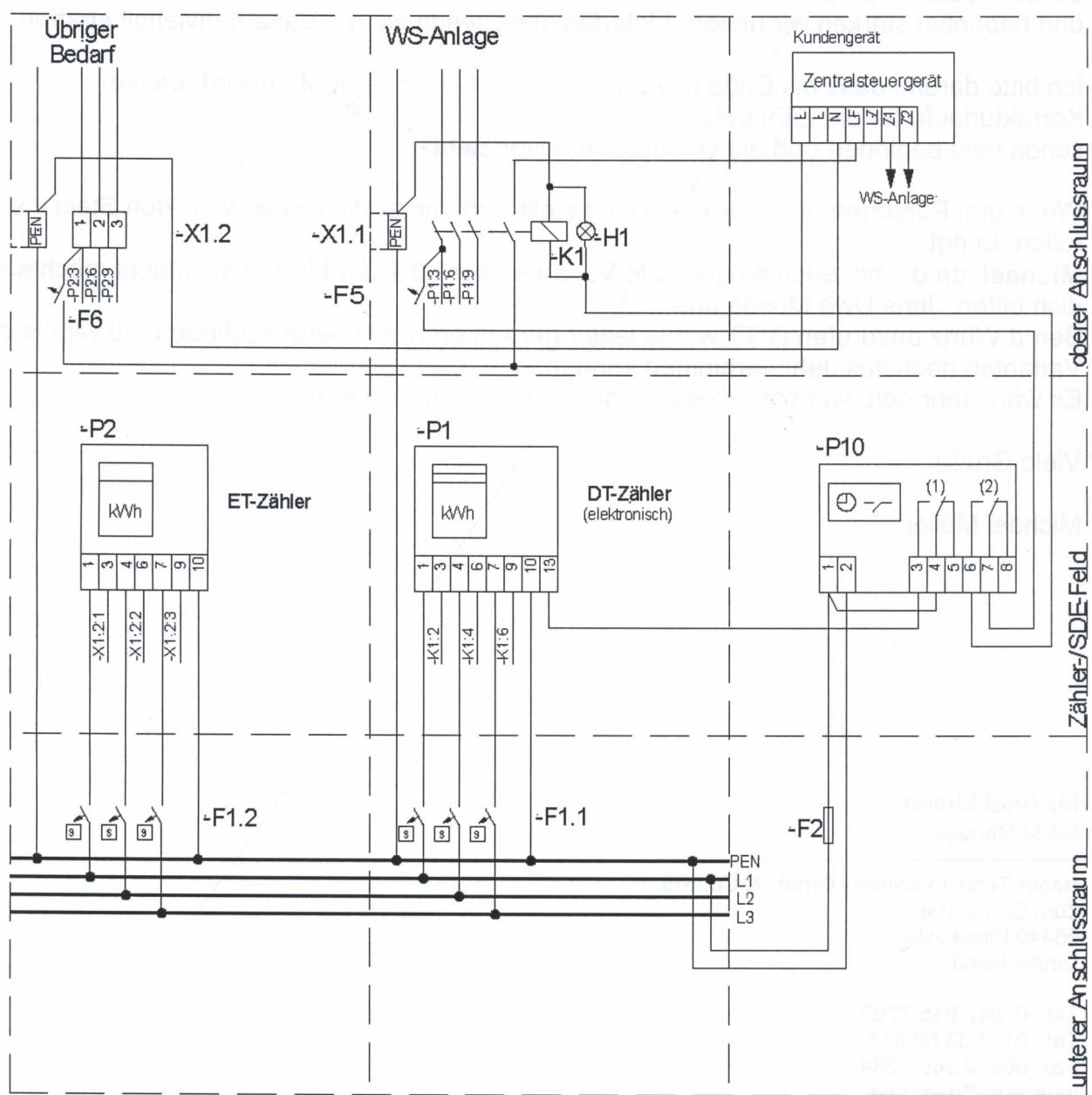
**Bild 4.7:** Freigabeschaltung für eine Wärmespeicherstrom-Einkundenanlage in variabler Dreipunktbefestigung
