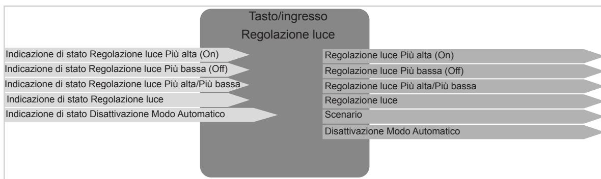
Figura 4: Segnali di ingresso/uscita funzione Regolazione luce
