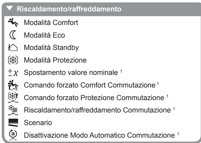
Figura 57: Panoramica delle funzioni **Riscaldamento/raffreddamento**
