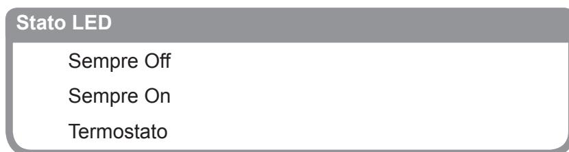
Figura 58: Modalità operativa LED di stato
