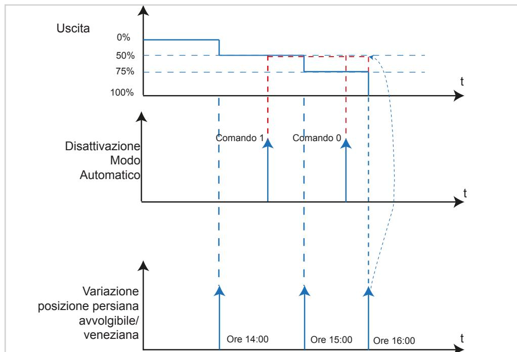
Figura 55: Diagramma segnale-tempo Disattivazione Modo Automatico
