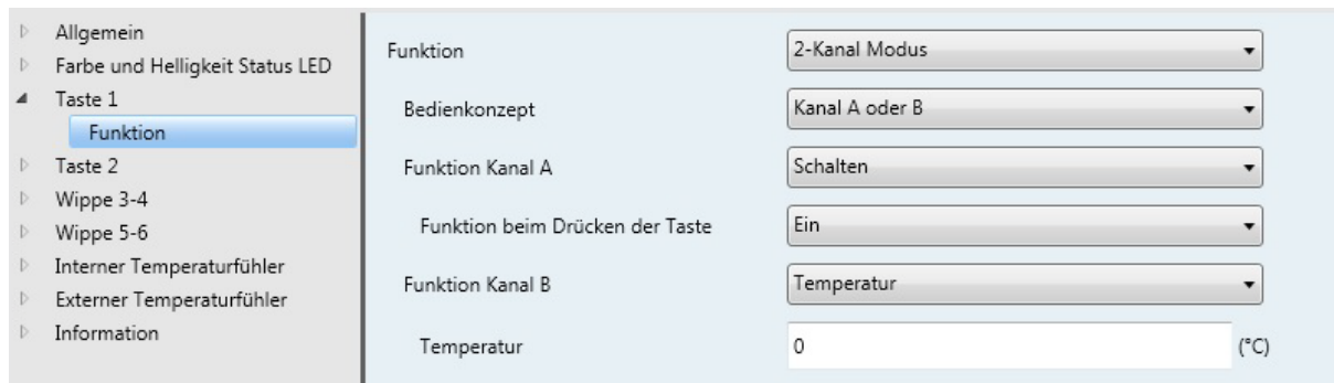
Bild 32: Parameter „Funktion 2-Kanal-Modus“
